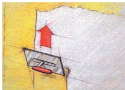
Штукатурка наносится нержавеющей гладилкой, структура образно вываается после обработки жесткой пластмассовой гладилкой
